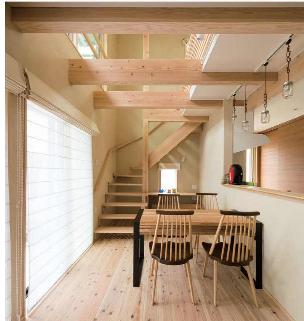
リビング 吹抜けが心地よいLDK。壁は珪藻土、床は無垢の杉材を使用。梅雨どきでも室内がジメジメしないそう
