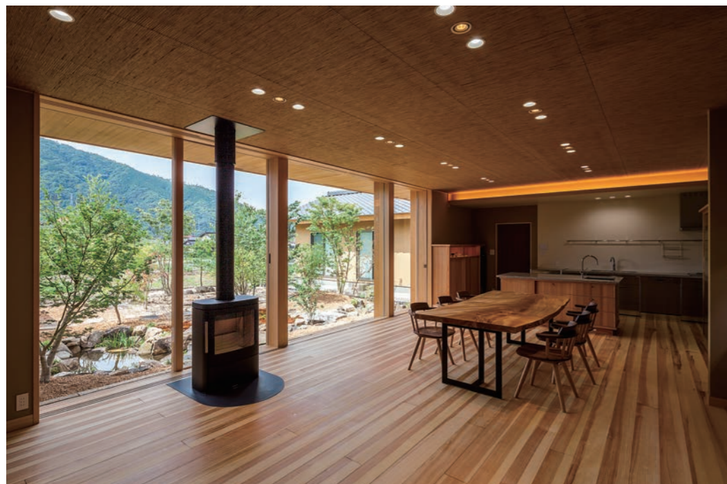
LDK① 大開口は建具框を隠し天井から床までガラスにする事で内と庭の境界に緩やかな繋がりをもたらす。Low-Eペアガラス+アルゴンガスと気密部材で断熱・気密を高めた。
